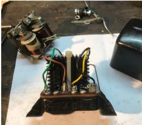
*Un régulateur Lucas MCR2 dont les bobines cramées cachera ce régulateur électronique à 12v raccordé à une dynamo Lucas E3LM contenant une bobine de champ 12v. Pas besoin de changer le faisceau de la Triumph T110 de 1956. On y installe des ampoules et une batterie à 12v et on est prêt pour rouler la nuit.*
