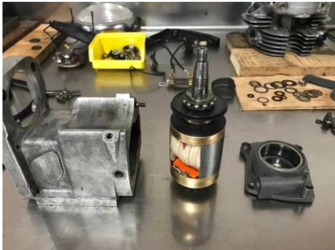
*L'induit de la MN12E rembobiné, il fallut isoler la borne de terre du condensateur d'origine qui servira toujours de point de fixation et contact électrique de la plaque du rupteur*
