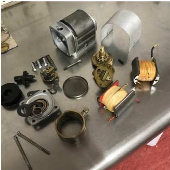
*Rembobinée et équipée d'un condensateur Easy Cap, cette magnéto HCO par Magnéto-France d'une Terrot 500 de 1938 attend son remontage et l'aimantation de ses aimants fatigués.*
