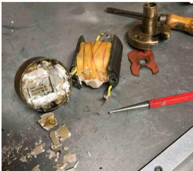
*20% des magnétos confiées à Ecurie35 contiennent des induits rembobinés dans les derniers 10 ans avec des condensateurs non adaptés. Ce n'est pas toujours possible de sauver le bobinage d'un induit dont le condensateur de remplacement encastré dans une résine mais dans ce cas, l'Écurie35 réussit et le bobinage, refait il y a seulement 3 ans, fut réutilisé.*
