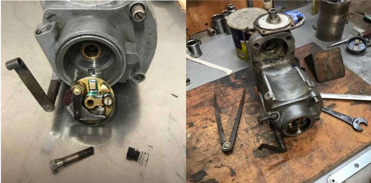
*Son induit rembobiné, la MN12E Magdyno fut équipée d'un condensateur dernier cri du type Easy Cap conçu et fabriqué par l'entreprise anglaise Brightspark Magnetos Ltd.*
