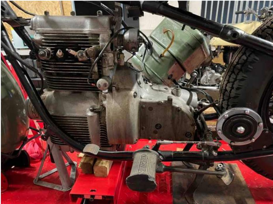
*Révision de l'allumage d'une Sunbeam S7 de 1950 ainsi que les points de montage du moteur dont les Silentbloc totalement pourris. Quelqu'un monta un condensateur externe au distributeur, modification assez logique mais pas nécessaire si on obtient pour commencer le bon condensateur.*
